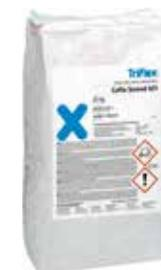
En cas d'utilisation d'un mixeur à deux batteurs, ajouter 2,25 l d'eau à 25,00 kg de Triflex CeFix Screed 631 et mélanger. Temps de mélange mini. : 2 min.
